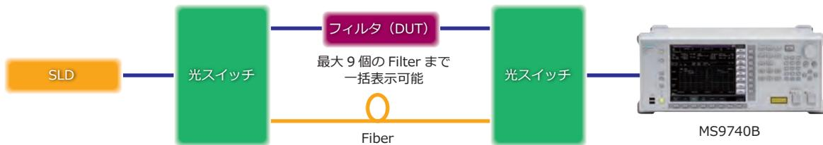
光バンドパスフィルタの評価では、DUT未挿入時と挿入時の測定結果の差分を求め、DUT挿入損失の評価が必要です。MS9740BのTrace機能を使用することにより、光スイッチなどを使用した測定において最大10個の測定波形を記憶し、波形間演算を使用して挿入損失の測定が行えます。また、同時に画面表示可能な最大10個の波形は、1ファイル上に保存できます。
